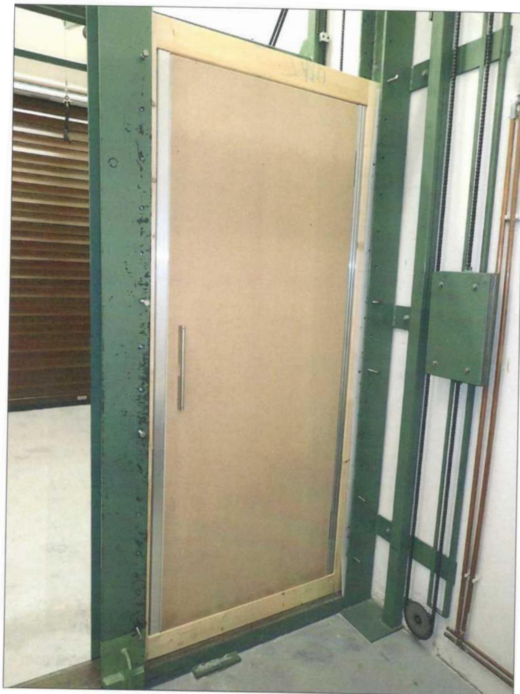
fot. 2 – próbka badawcza zainstalowana w ramie do badań – strona poddawana obciążeniu (zewnątrzna)
