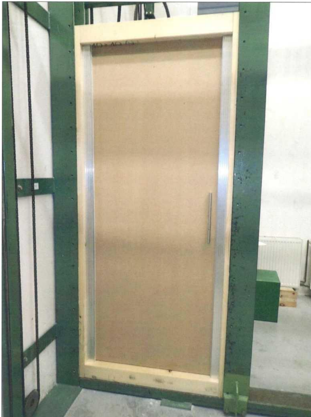
fot. 1 – próbka badawcza zainstalowana w ramie do badań – chroniona (wewnętrzna)
